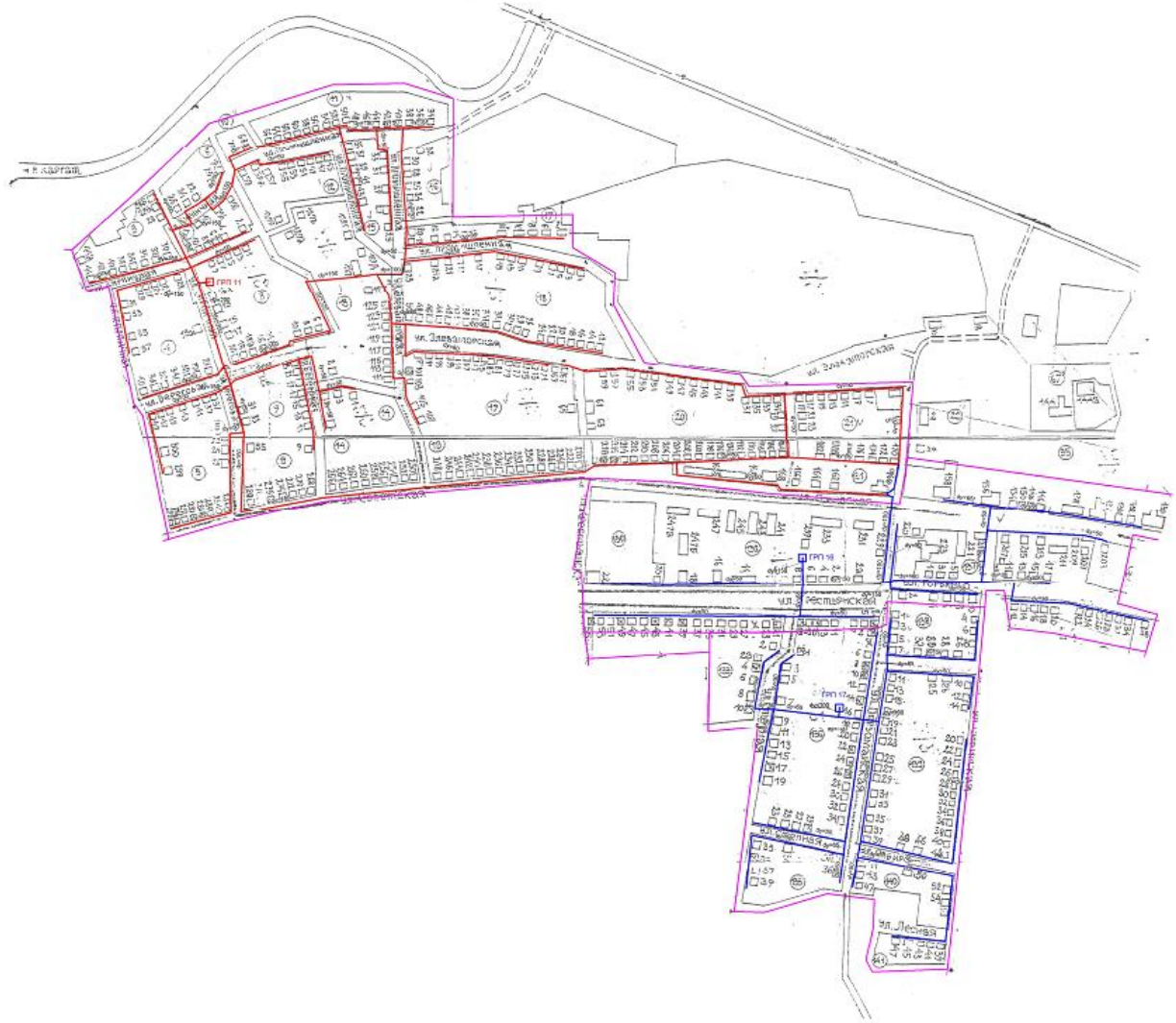
Существующий и перспективный газопровод низкого давления, Р до 250 мм в ст. от ГРП 11, 16, 17, г. Юргат Юргатского района Новосибирской области Карта М1:2 500
